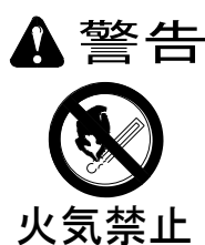
火気禁止 充電中、ガスが発生し爆発の危険があります。 4008769
