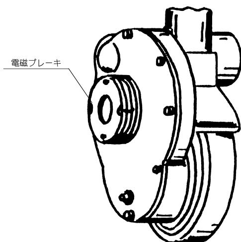
1. ギャップ調整用ナット（内側）3カ所をゆるめる。
